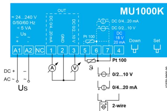
Bei Anschluss eines Temperatursensors Pt100 in 2 Leiter Ausführung müssen die Klemmen 6 und 7 miteinander verbunden werden.
