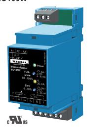
Artikelnummer: T236041 Der MU100W wandelt die Stellung eines Widerstandspotentiometers um in ein proportionales Signal 0/4-20 mA bzw. 0-10 V. Der Nullpunkt kann von 0...40 % und der FullScale von 60 ... 100 % des Einstellbereichs des Potentiometers einfach per Tastendruck abgeglichen werden.
