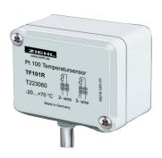
Raumtemperatursensor für Innen- und Außenmontage. Schutzart IP 54, Kabelzuführung über Verschraubung M12. Für Weiterleitung in 2- oder 3-Leitertechnik geeignet.
