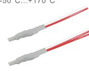
Sensor, in Streichholzgröße, mit Schrumpfschlauch geschützt. Die Bauform TF101/K eignet sich zum Einbau in Trafo- und Motorwicklungen. Beim Einbau in Wicklungen ist darauf zu achten, dass der Messwiderstand keinem Druck ausgesetzt wird und keine Zugbelastung auf das Kabel entsteht. Ansprechzeit T<sub>0,9</sub> in Luft 100 s, in Wasser 19 s.
