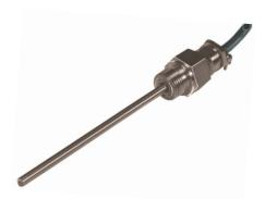
Messwiderstand eingebaut in Edelstahlrohr V4A mit Einschraubgewinde 1/2 Zoll zum Einbau in Rohrleitungen. Ansprechzeit T0,9 in Luft 255 s, in Wasser 45 s. Steckanschluss Flachstecker 2,8 mm, Dichtung IP55, Klemmbereich 8-12 mm, Kabelanschlusskopf max. 100 °C
