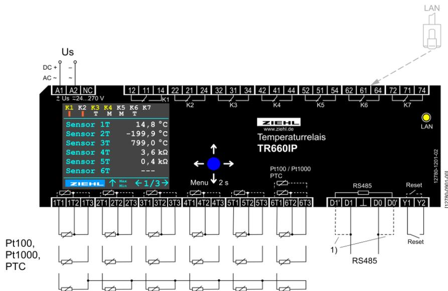
**ACHTUNG!** Beim letzten Gerät im RS485 Bus müssen die Brücken „1)“ von D1 nach D1' und von D0 nach D0' eingeschraubt werden. Drahtbrücken sind nicht im Lieferumfang enthalten.
