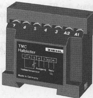
Der Halbleiter - Meßumformer Typ TMC ist für verschiedene Temperaturbereiche lieferbar. Als Meßfühler werden Silizium-Sensoren mit einem PTC-Verhalten verwendet. Dieser Fühlertyp arbeitet wegen seines großen Temperaturkoeffizienten ohne Leitungskompensation.
