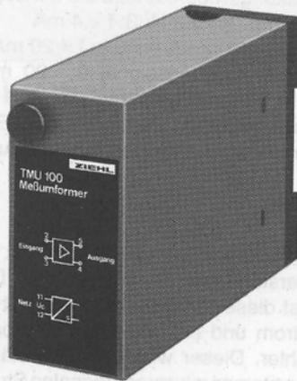
Thermoelement - Meßumformer Typ TMU sind für verschiedene Temperaturbereiche lieferbar. Als Meßfühler werden Thermoelemente nach DIN 43 710 und DIN-IEC 584-1 verwendet. Die Vergleichsstellenkompensation erfolgt elektronisch durch einen eingebauten Temperatursensor. Damit ermöglichen Meßumformer vom Typ TMU den direkten Anschluß von Thermoelementen.
