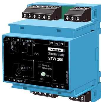
Stromrelais STW200 überwachen Wechselströme auf Unterschreiten einer eingestellten Schwelle. Mit den Messbereichen 12 ... 120 mA und 0,1 ... 1 A können LED-Leuchten und Glühlampen auf Funktion überwacht werden. Bei Ausfall des Betriebsleuchtmittels wird auf das Reserveleuchtmittel umgeschaltet und ein Meldekontakt signalisiert den Ausfall. Soll bei Ausfall des Reserveleuchtmittels eine Alarmierung erfolgen, so wird einfach ein zweites STW200 eingesetzt.
