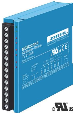
Das Kaltleiter-Relais MSR220K6 überwacht bis zu 6 Kaltleiterkreise gleichzeitig. Tritt in einem Kreis eine Übertemperatur auf, so schaltet das eingebaute Relais ab und LEDs signalisieren, in welchem Kreis die Übertemperatur aufgetreten ist. Die Abschaltung bleibt bis zu einem Reset gespeichert. Damit kann festgestellt werden, welcher Kaltleiterkreis die Auslösung verursacht hat, auch wenn dieser inzwischen wieder abgekühlt ist.
