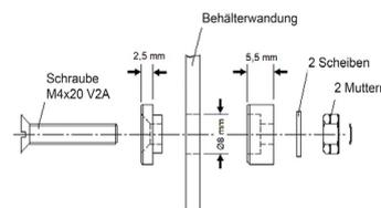
Als Elektroden sind isolierte Schraubelektroden zur Befestigung in Behälterwänden lieferbar. Das Elektrodenmaterial ist V 2 A, das Material für die Isolierung ist Teflon.
