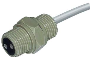
Die Niveausonde NE2 kann mit ihrem 1/2"-Gewinde direkt in Behälterwände eingeschraubt werden. Die beiden Elektroden aus Edelstahl V4A sind mit Gießharz bündig in ein Kunststoffgewinde (Polypropylen, PP) eingegossen. Die Niveausonden können im Temperaturbereich -5...+60°C eingesetzt werden und sind druckfest bis 6 bar. Das fest eingegossene, 2000 mm lange Anschlusskabel aus PVC mit 2 Adern je 0,25 mm<sup>2</sup> hat einen Durchmesser von 4 mm.
