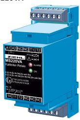
Motorschutzgerät zum Einsatz als Schutzeinrichtung gegen unzulässige Erwärmung an elektrischen Betriebsmitteln in gasexplosionsgefährdeten Bereichen (Zonen 1 und 2) und in Bereichen mit brennbarem Staub (21 und 22), z.B. zur direkten Temperaturüberwachung explosionsgeschützter Motoren der Zündschutzart Ex e und Ex d.
